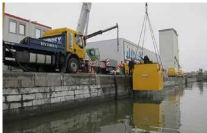
Test met een prototype van een gesloten baggersysteem bij Hydrex (Asiadok)
